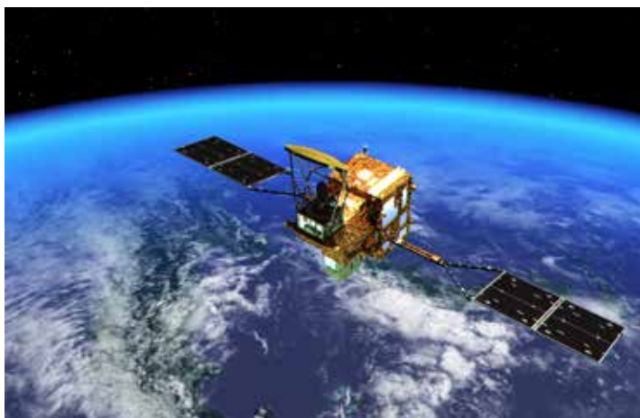
水循環変動観測衛星「しずく (GCOM-W)」。海面や海水、大気から放射される微弱な電波を捉え、水に関する様々な物理量を観測する (c) JAXA
